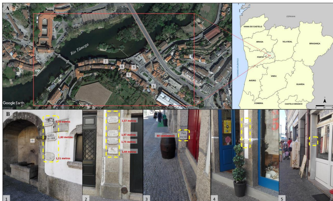
Figura 279 A) Enquadramento geográfico da área de estudo; B) Marcas de cheias existentes no centro histórico e urbano de Amarante (a altura indicada é referente à altura da coluna de água a partir do nível da respetiva rua).
