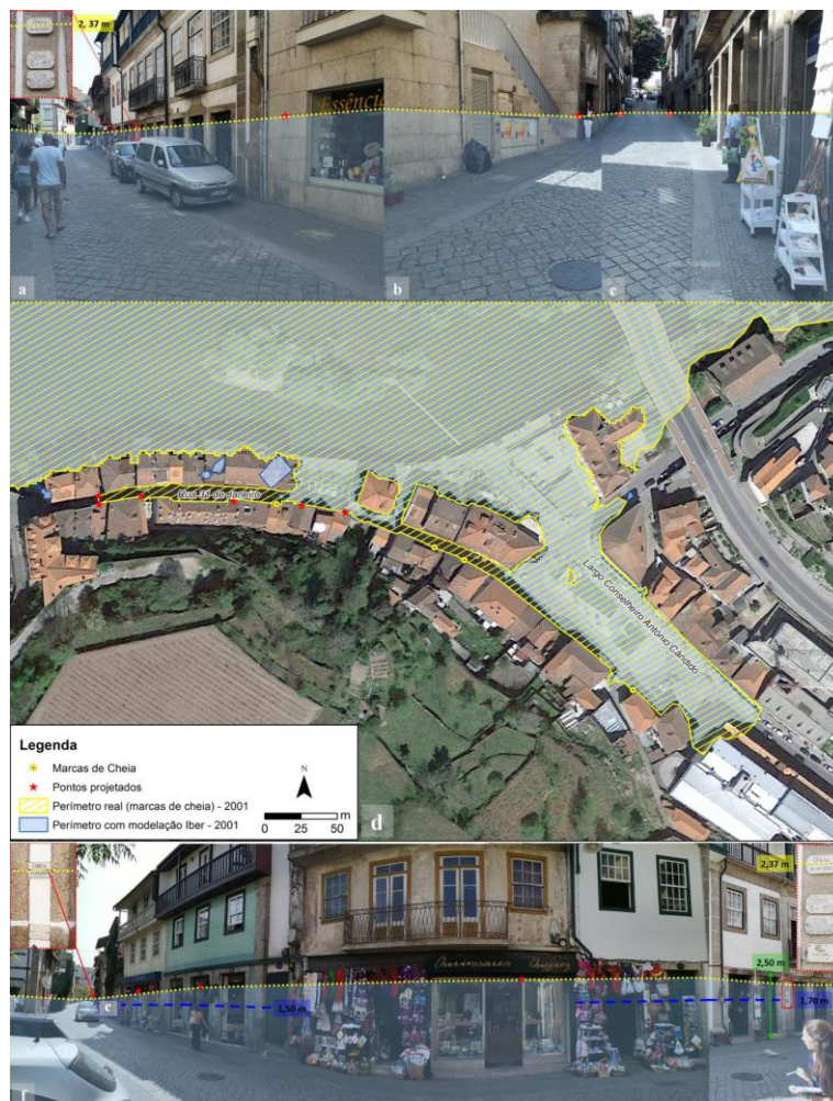
Figura 281 Metodologia seguida na definição do perímetro real da cheia de 2001 através das marcas de cheia; Projeção da altura da coluna de água atingida na área inundada através das marcas de cheia de 2001 (a, b, c, f); Comparação dos perímetros de inundação obtidos pela modelação hidráulica e pelas marcas de cheia de 2001 (d); Altura da coluna de água atingida em determinados setores com a modelação hidráulica (tracejado azul (e)).
