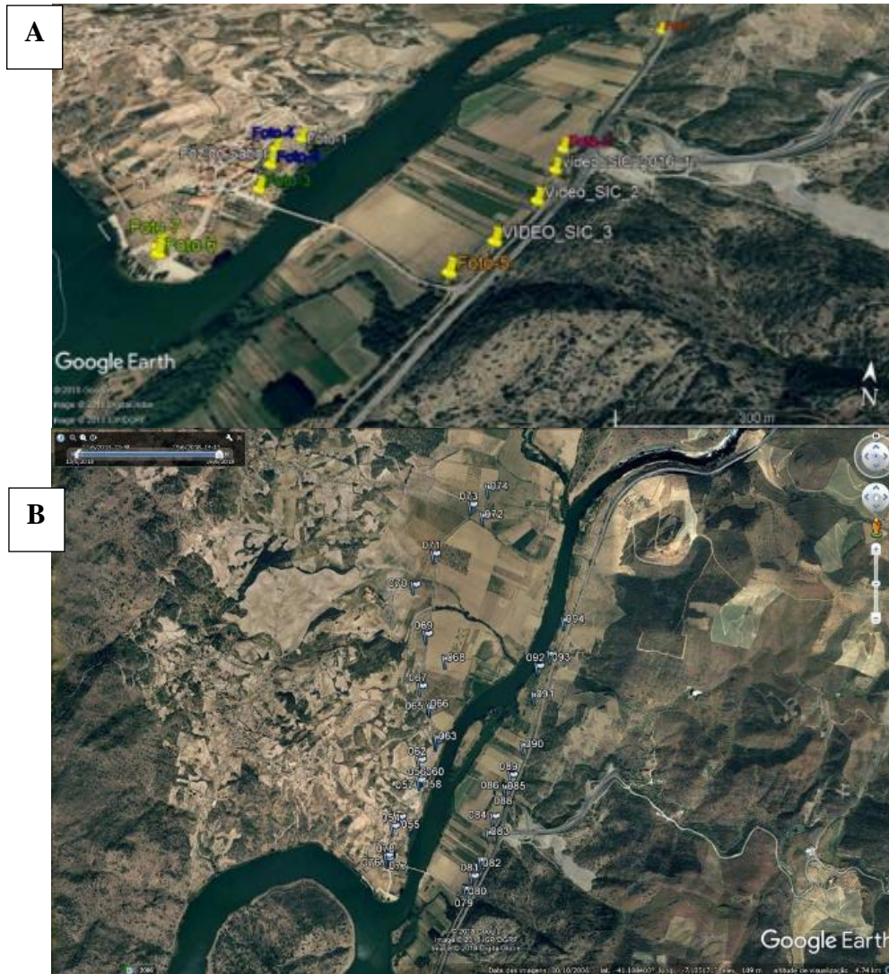
Figura 286 A) Localização das diferentes marcas de cheia e respetivas fotos relativas à cheia de 2010. Fontes: Blogs “O cantinho do Jorge” e “Torre. Moncorvo”; B) Marcas de cheia inventariadas no terreno através de GPS para a reconstrução hidro-histórica do perímetro de inundação ocorrido em 1962.
