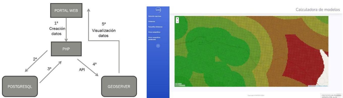
Figura 4. Procedimiento para la inserción de datos y ejemplo de visualización
